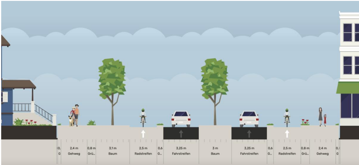
Regelquerschnitt Kastanienallee 1. Bauabschnitt
