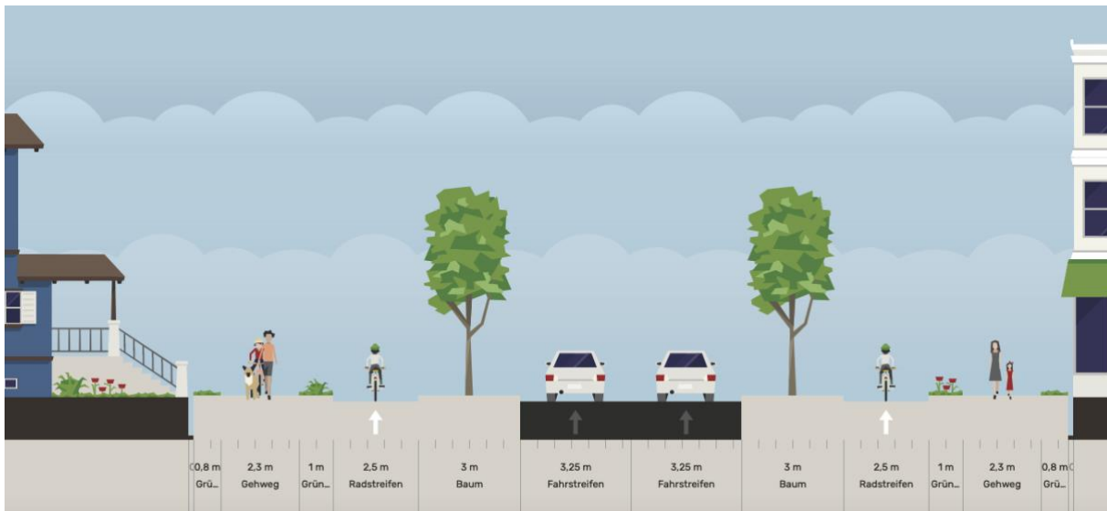
Regelquerschnitt Kastanienallee 1. Bauabschnitt
